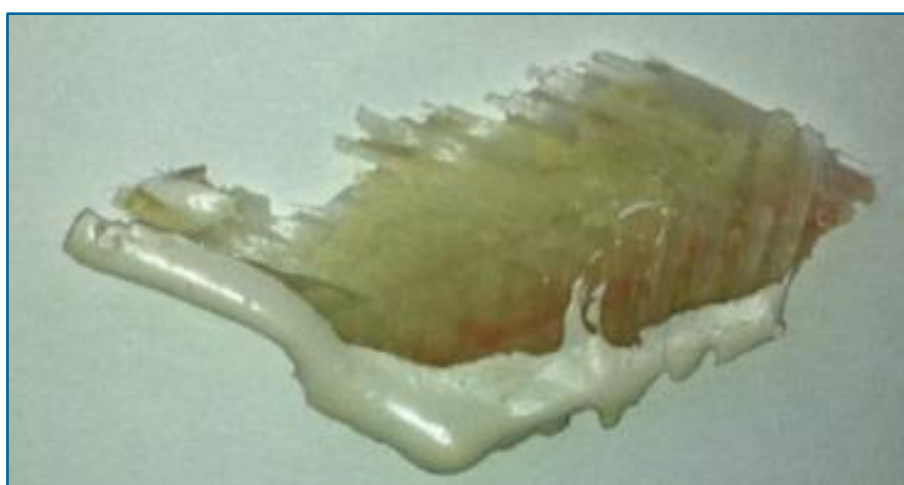
Рис.74. Образец острой отделки из стекловолокна, эпоксидной смолы и белой краски (фото: Piero Medici, 2011)
