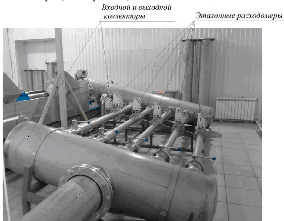
Рис. 1.2.2. Пример гребенки с эталонными расходомерами (расходомерная установка Тайфун 1000, ООО «Водомер» г. Мытищи)
