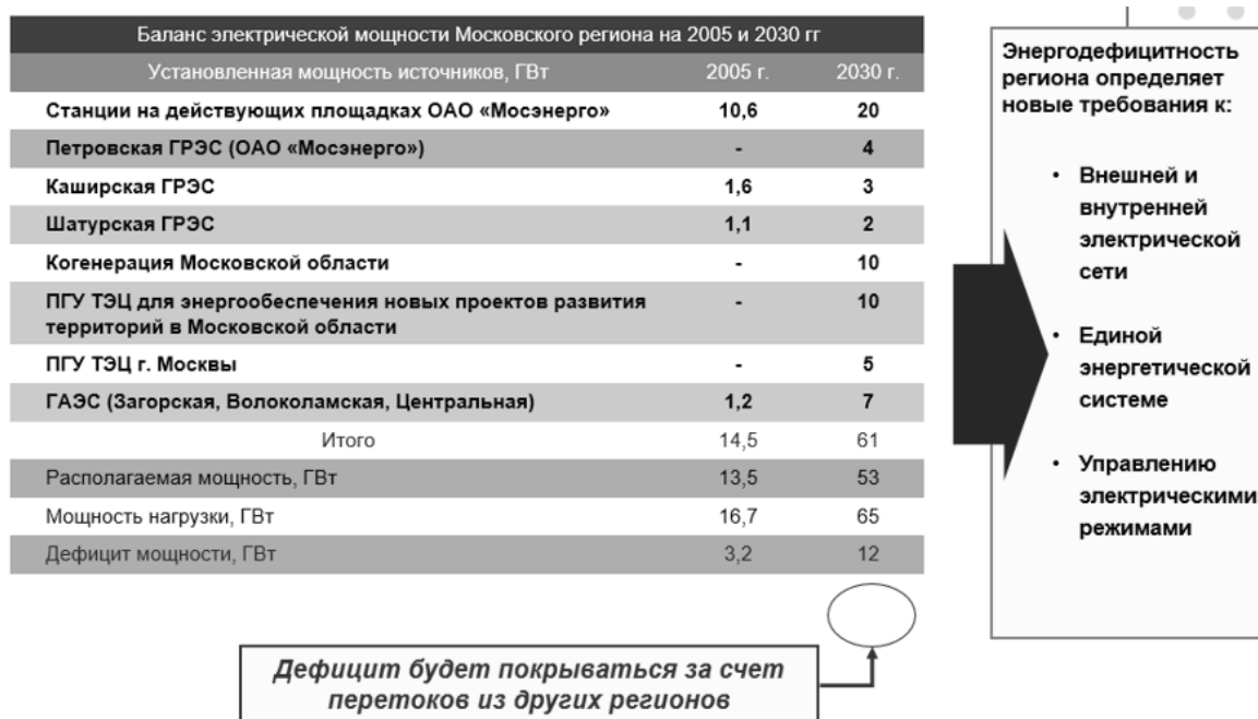
Рис. 1.12. Прогнозный баланс электрической мощности Московской энергосистемы в 2030 г.
